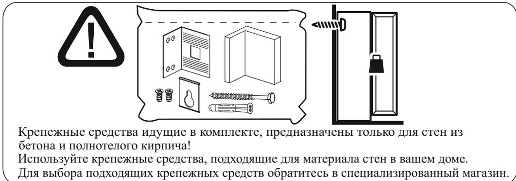
Крепежные средства идущие в комплекте, предназначены только для стен из бетона и полнотелого кирпича!
